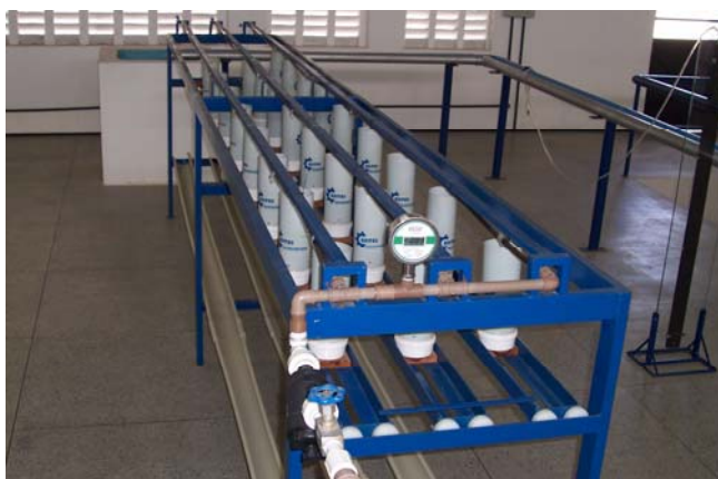
Figura 1 – Bancada para ensaios em gotejadores
